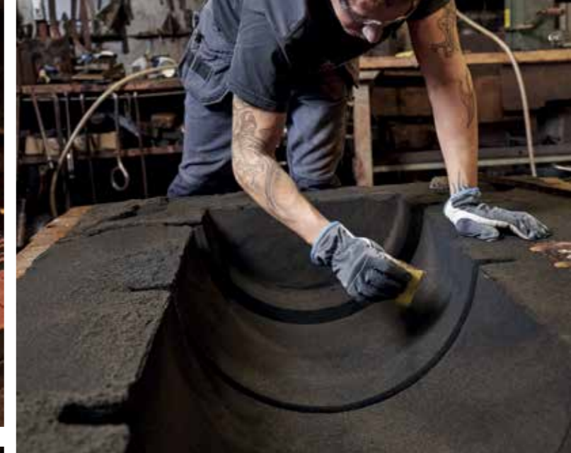
Färdigställande av gjutformar.
